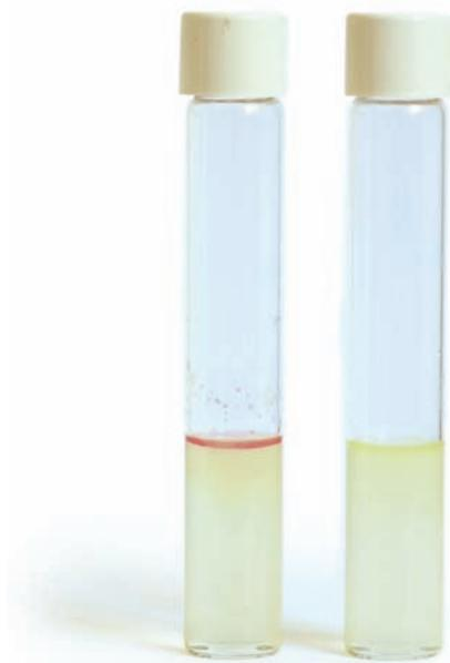
Tryptophan-Peptonwasser – positive Reaktion mit deutlich sichtbarem kirschroten Ring (links), bei Anwesenheit von *E. coli* und farblos bei negativer Reaktion (rechts)
